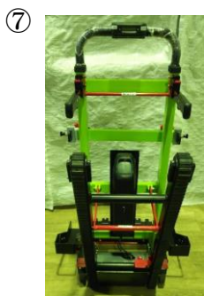
⑦ヘッドレストを取り外し、赤いレバーを前に押し昇降時ハンドルを下げます。
