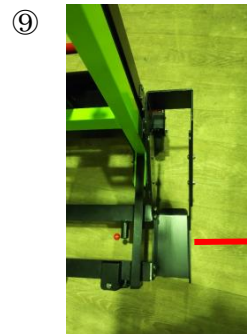
⑦ヘッドレストを取り外し、赤いレバーを前に押し昇降時ハンドルを下げます。
